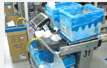
〔重量検品機付きカートピッキングシステム〕
