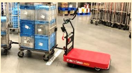
AGV（自動搬送ロボット）
